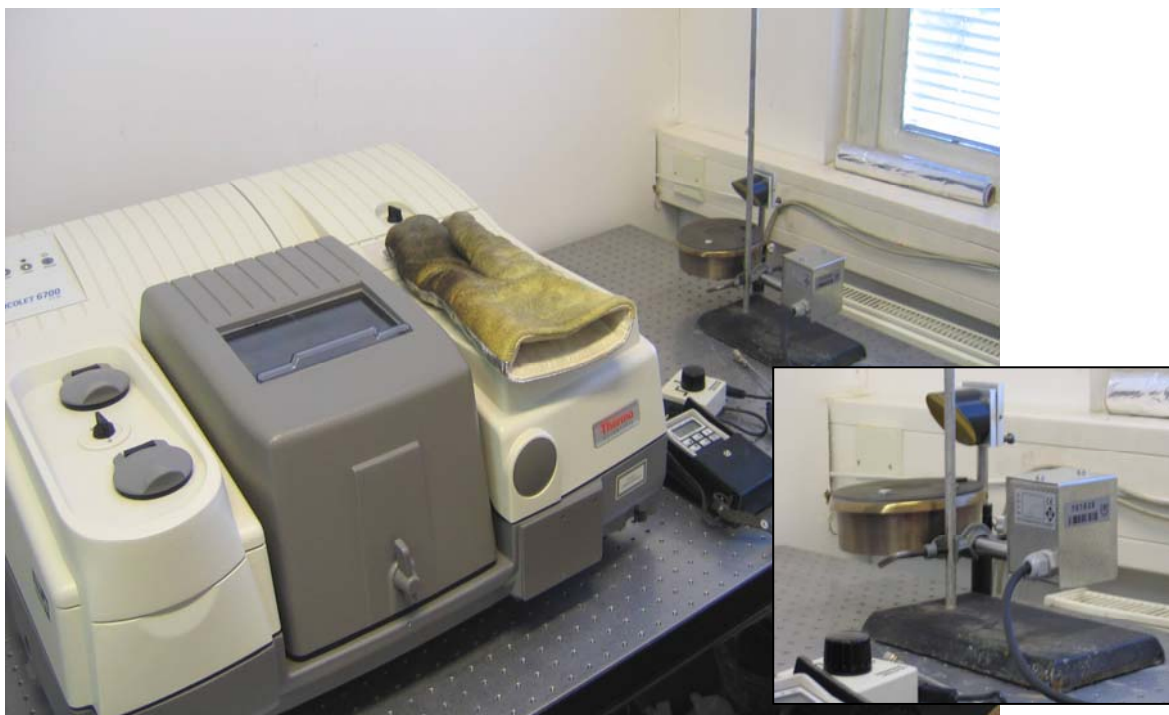
Obr. 3.14: Uspořádání pracoviště měření emisivity pomocí infračervené spektrometrie. 1 – zdroj záření (plotýnka nebo vzorek o definované teplotě), 2 – apertura, 3 – nepoužívané beamsplitters, 4 – pevné zrcadlo, 5 – beamsplitter, 6 – pohyblivé zrcadlo, 7 – otočné zrcadlo, 8 – detektor, 9 – vzorkový prostor, 10 – vnější parabolické zrcadlo, 11 – napájení topné desky, 12 – termočlávková dotyková sonda, 13 – přepínač termočlávků, 14 – záznam měřené teploty
