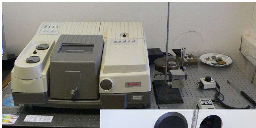
uspořádání s příslušenstvím pro měření emisivity vzorků
