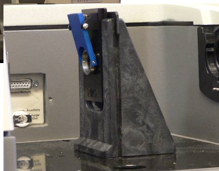
uspořádání s nástavcem na měření propustnosti vzorků
